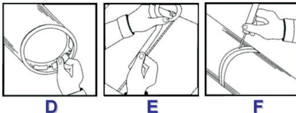
**D.** Nun lösen Sie den Schutzüberzug des Adhäsivbandes vom eigentlichen Klebeband und befestigen dann das Dämmpapier an der vorgesehenen Stelle. Es ist ratsam, eine kleine Öffnung in der Membrane anzubringen, damit beim Spülen die Luft entweichen kann.
