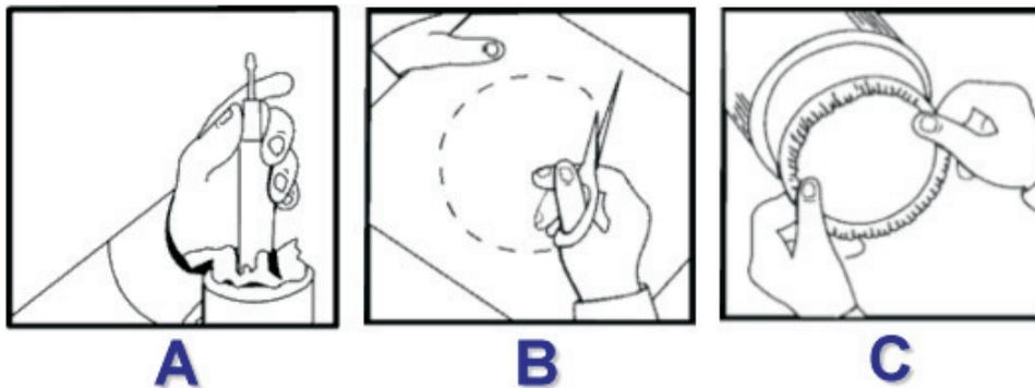
**A.** Bei kleinen Rohrdurchmessern bis etwa 100 mm i.D. stopfen Sie das dünne DISSOLVO Papier WLD 35 einfach beidseitig der Schweissnaht in das Rohr.
